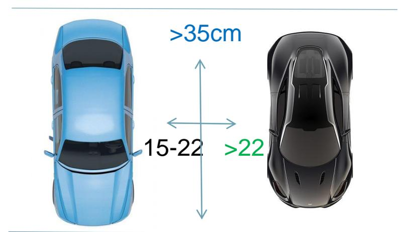
Der Roboter entscheidet anhand Länge und Tiefe die Parkmöglichkeiten. Die Tiefe misst der Roboter mit den Ultraschallsensoren in cm und die Länge ermitteln wir mithilfe der Variable „timer“, die angibt wie viele Zehntelsekunden der Roboter mit der Geschwindigkeit 50% vorwärtsfährt. Die Unterscheidung der einzelnen Parksituationen entscheidet der Roboter anhand der oben dargestellten Werten (Schwarz = kleine Länge, grün = große Länge, blau = Tiefe)
