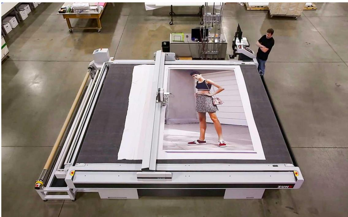
*Per il taglio del tessuto, Moss utilizza principalmente sistemi da taglio Zünd da 3,2 metri di larghezza, configurati con conveyor, sbobinatore per jumbo roll e utensile con lama rotante.*
