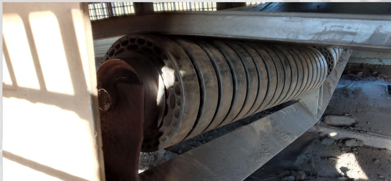
Durante o período de prova **não houve apontamento de falha** relacionada ao lote testado, assim como não apresentaram nenhum desgaste acentuado nos anéis poliméricos, travamento de rolamentos ou quebra do eixo.
