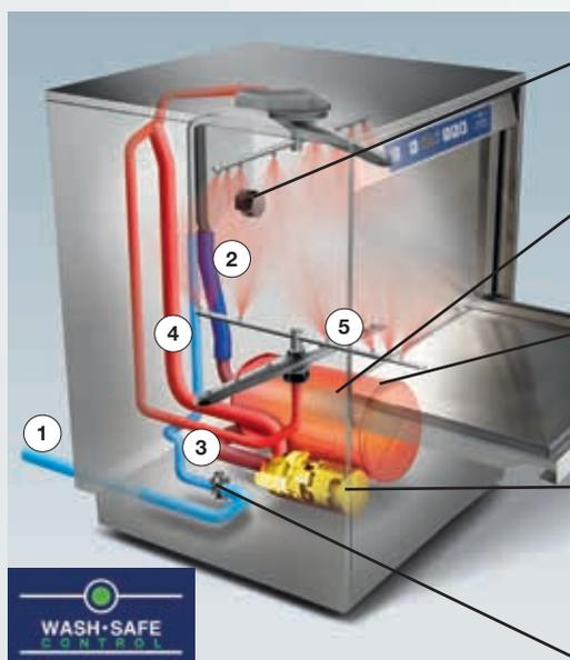
Il **salto in aria** impedisce il ritorno dell'acqua di lavaggio nella rete idrica nel caso di un improvviso calo di pressione
