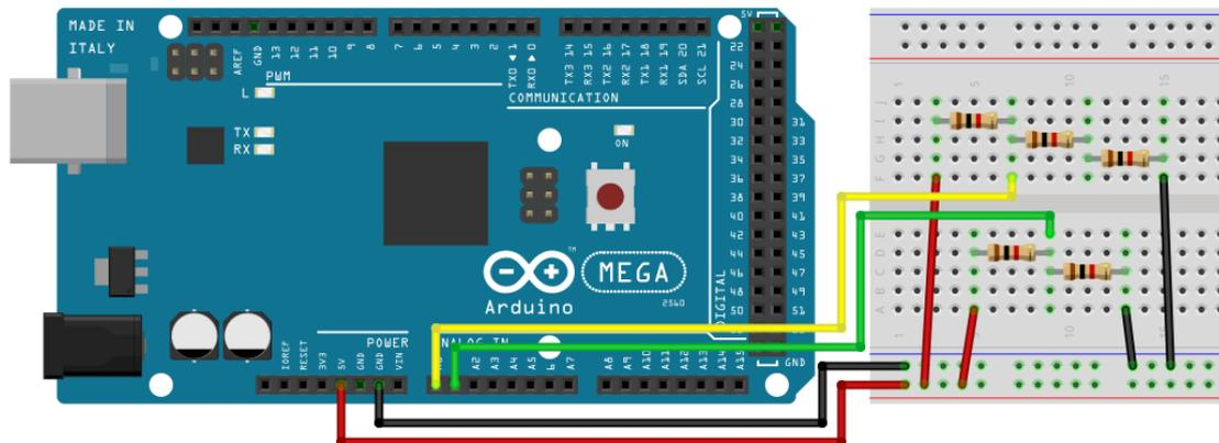
Esse é um diagrama com dois divisores de tensão. O primeiro é composto por três resistores, sendo cada um de 330R. Assim, o resistor Z1 é de 330R e o resistor Z2 é formado pela associação em série dos outros dois, resultando numa resistência equivalente de 660R.
