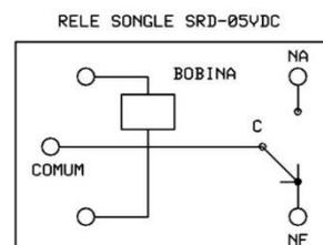
O terminal C é o Comum do Contato. Os outros dois terminais usamos para ligar ou desligar a carga. Se ligamos a carga no terminal NA, a carga será acionada quando enviarmos um sinal. Se ligarmos a carga no pino NF, ela será ativada setando o pino de controle do Arduino para nível baixo, e desligada setando o pino de controle para nível alto.
