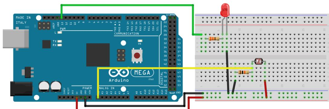
No diagrama, o sensor é ligado como parte de um divisor de tensão no pino analógico A0, de forma que a tensão de saída do divisor varia de acordo com a variação da resistência do sensor. Assim, vamos identificar as variações na intensidade de luz pelas variações na tensão do sensor.
