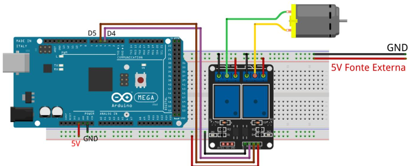
Código Arduino – Ponte H com módulo relé 2 canais
