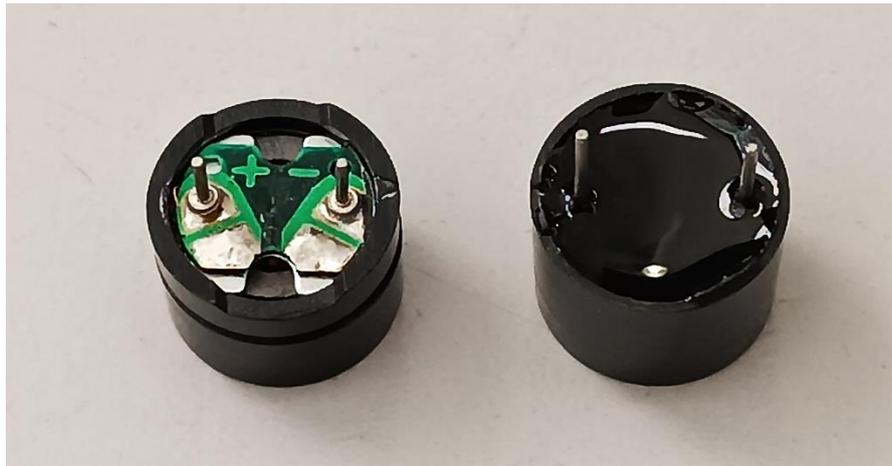
*Buzzer passivo e buzzer ativo, respectivamente*
