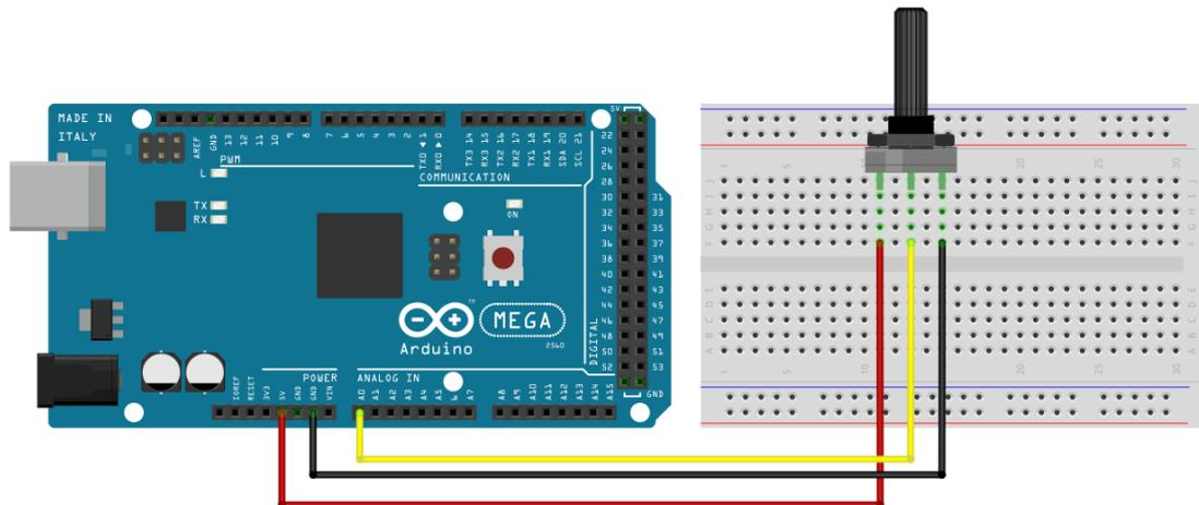
O Potenciômetro possui 3 terminais, sendo que o do meio é o que possui resistência variável. A ligação consiste em ligar os dois terminais fixos a uma tensão de 5V. Assim, o terminal intermediário do potenciômetro terá um valor que varia de 0 a 5V à medida que você gira seu knob.
