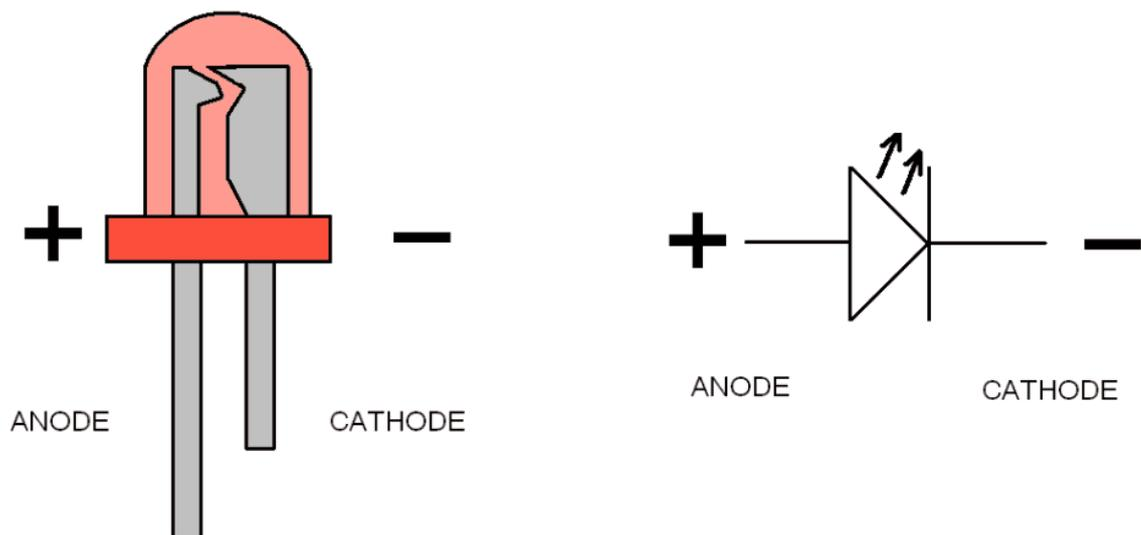
Figura 5: Terminais de um Led. Créditos: Build-eletronic-circuits.com
