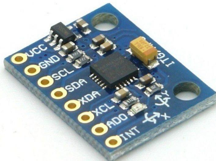
Sobre este módulo para Arduino, ele se chama GY-521. onde ele já vem com um regulador de tensão, que permite o módulo ser usado de 3-5V e com a opção de soldar pinos que se encaixam em protoboard. Os pinos presentes são
