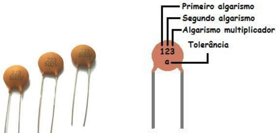
Figura 4: Capacitores cerâmicos
