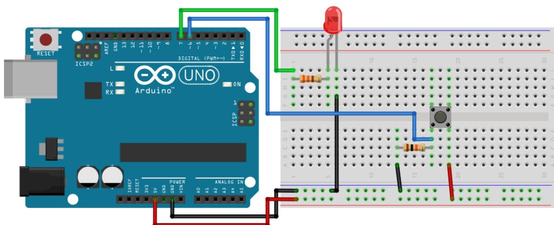
Esse pequeno código abaixo mostra como ler entradas digitais e como acionar as saídas digitais. Na função **void setup()**, é preciso configurar qual pino será usado como saída e qual será usado como entrada.
