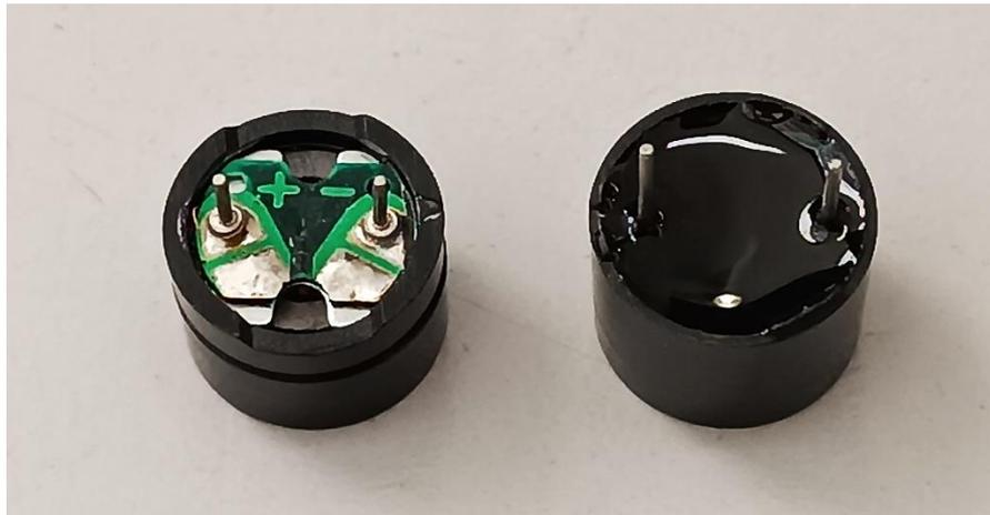
*Buzzer passivo e buzzer ativo, respectivamente*
