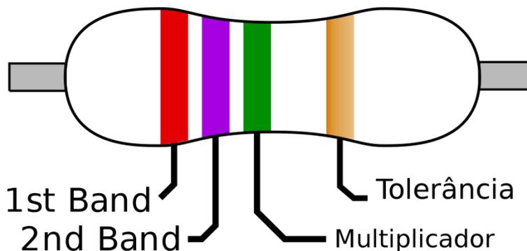
Figura 1: Faixas coloridas em um resistor
