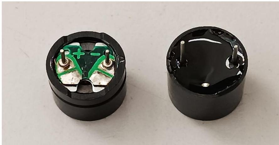
*Buzzer passivo e buzzer ativo, respectivamente*
