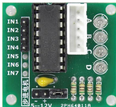
O pino mais à esquerda (-) no módulo é o terra (veja foto acima). Esse terra tem que ser conectado ao terra da fonte e ao terra do Arduino. O pino (+) no caso do Motor 28BYJ-48, tem que ser conectado ao positivo de uma fonte de 5V (preferencialmente de 1 Ampère). Não recomendo que conecte no 5V do Arduino, pois poderá sobrecarregar o regulador de tensão do mesmo. O jumper Power ON/OFF é usado
