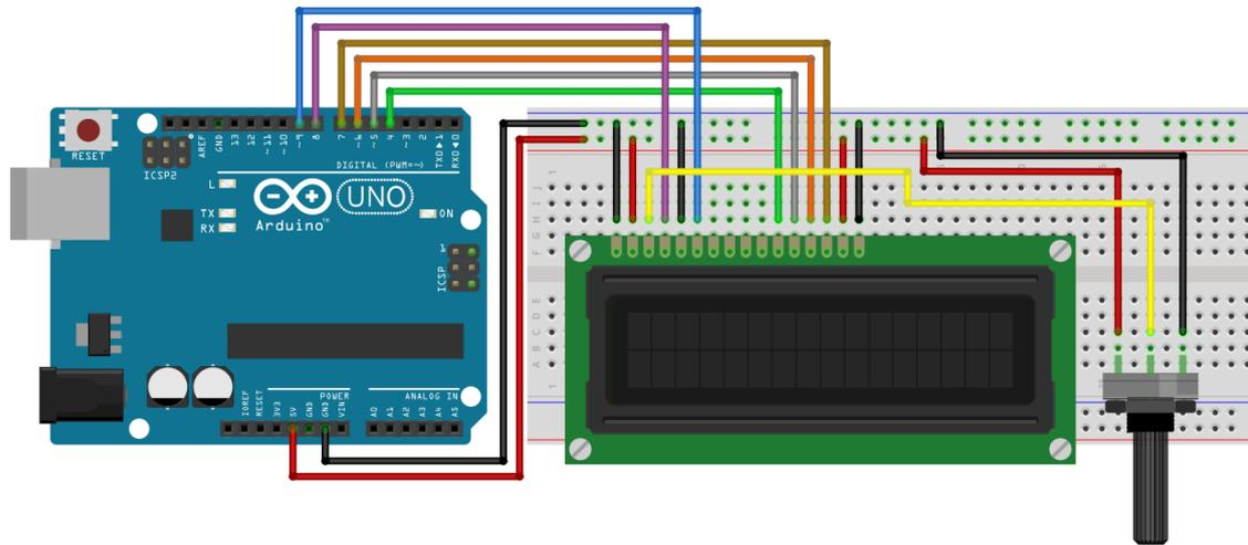
No diagrama acima, o potenciômetro é usado para controlar o contraste do LCD, e deve ser ajustado sempre que você ligar o display para poder visualizar bem cada caractere. As demais ligações são padrão.
