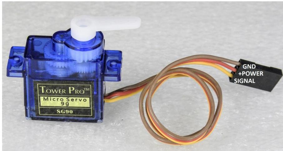
Os Servos são acionados por meio de três fios, dois para alimentação e um correspondente ao sinal de controle para determinar a posição. Em geral, os três fios são:
