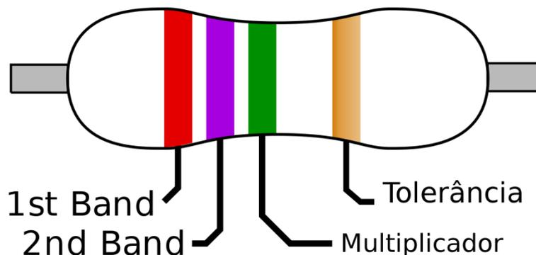
Figura 1: Faixas coloridas em um resistor
