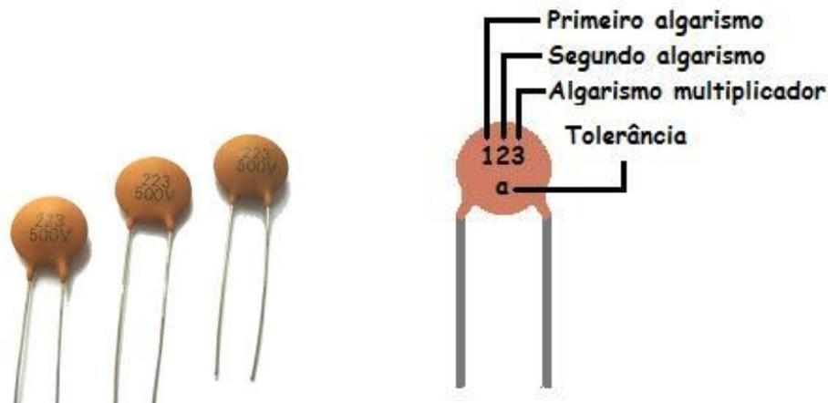
Figura 4: Capacitores cerâmicos
