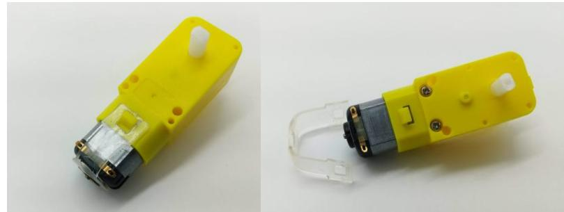
Agora pegue 2 fios, solde ao motor e faça um acabamento colocando um pouco de cola quente, para evitar qualquer tipo de curto-circuito ou contato indesejado.
