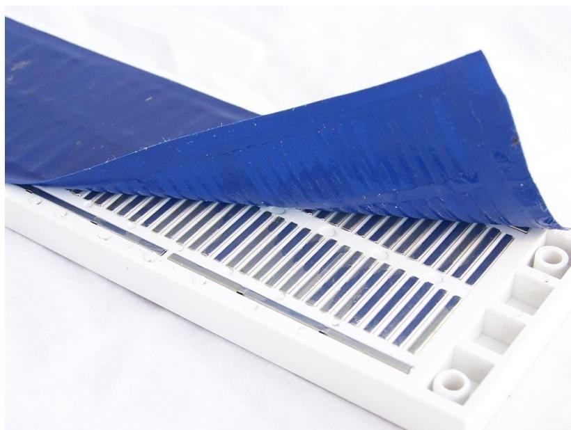
Toda linha vertical que vem 5 pontos unidos, como essas 5 marcadas na imagem, está conectada uma a outra fisicamente. A fins de curiosidade, internamente há uma ligação física de cobre, o que significa que todos os pontos são como se fossem um só, uma emenda perfeita, não importando se está ligando um fio no primeiro ponto e outro no último. Mas vale frisar: a emenda só vale entre 5 furos juntos quando estão na vertical.
