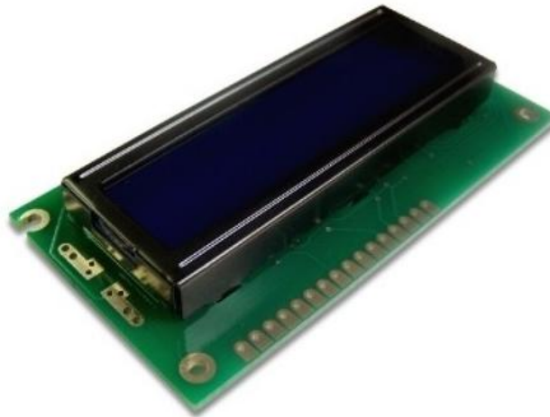
LCD 16x2. Créditos: Eletrogate
