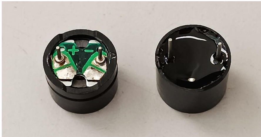
Buzzer passivo e buzzer ativo, respectivamente
